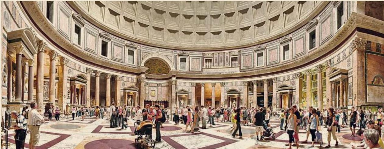
Das Pantheon lässt bis heute Romtouristen staunen. Das Bauwerk aus antikem Spezialbeton trägt nach wie vor die größte nicht durch Stahl verstärkte Betonkuppel der Welt.
