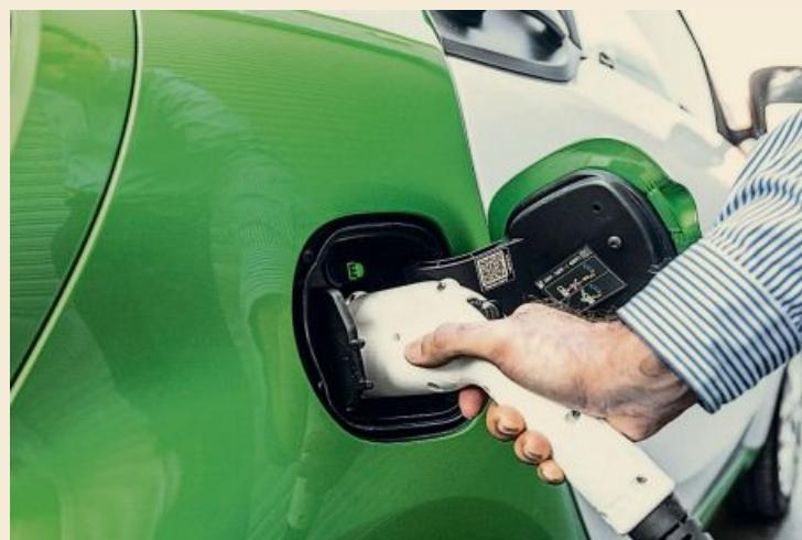
Mit neuer Ladetechnik kann mit bis zu 22 kW getankt werden. In einer Dreiviertelstunde ist die leere Batterie wieder voll.
